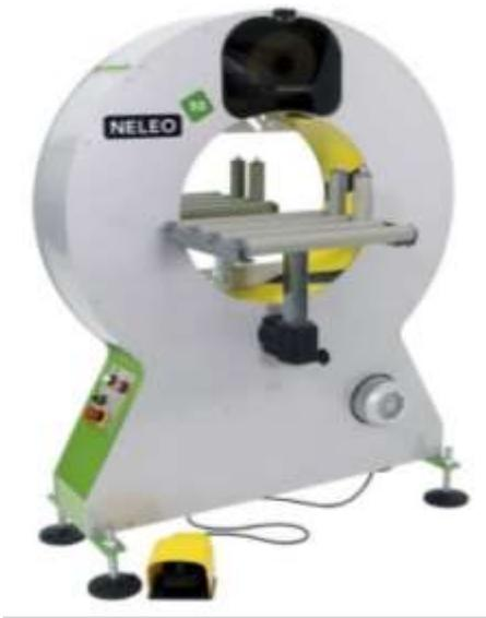
Banderolage, groupage et protection de produits longs tels que : moulures, barres d'aluminium, tubes, persiennes, etc.
